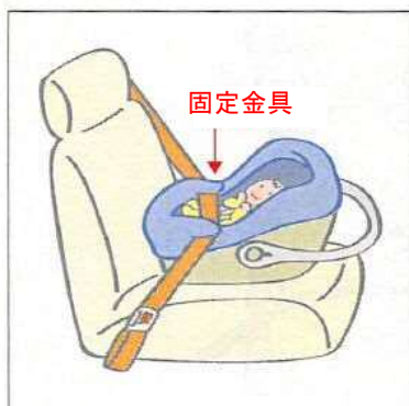
後ろ向き取り付けタイプ ● 2点固定式
