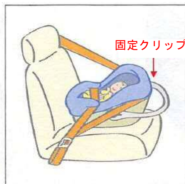
後ろ向き取り付けタイプ ● 3点固定式
